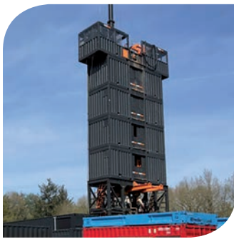
De mobiele opruiminstallatie (P&A Unit) gaat vanaf juni de winningsputten Sleen-4 en Sleen-7 aan de Kanaaldijk-Zuidzijde bij 't Haantje permanent afsluiten.
