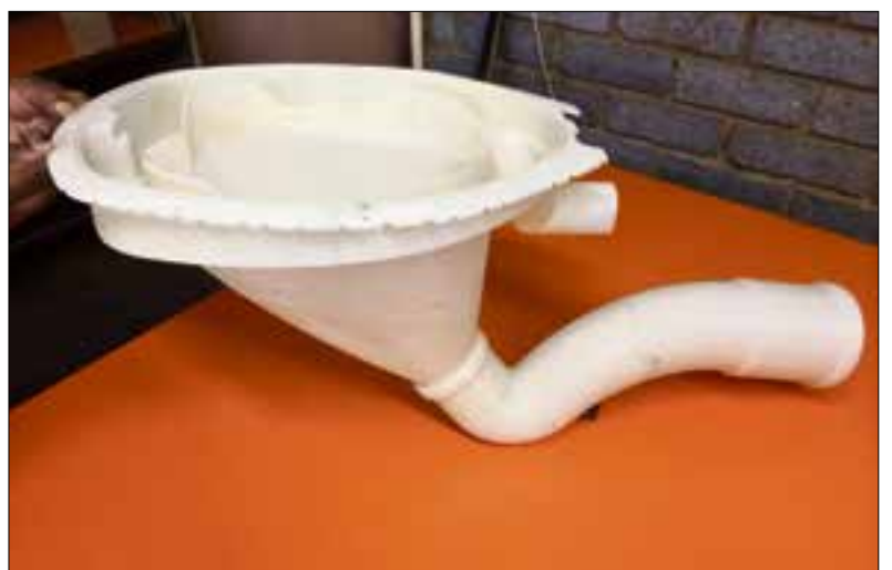
Een toilet uit de 3d printer. 3d printing is een van de bedreigingen voor de installatiesector.
