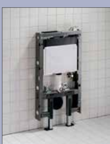
Het frame van de Geberit Monolith is op vier plaatsen verankerd aan de bouwconstructie en het reservoir wordt aan de bestaande wateraansluiting aangesloten.
