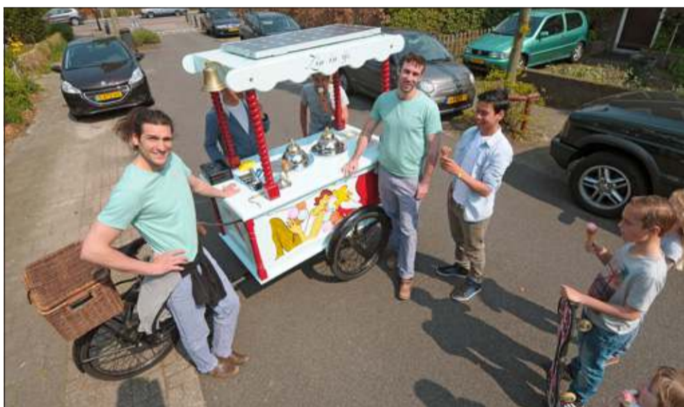
Igor (links) en Jorg bij hun zelfgebouwde ijskar met op het dak het zonnepaneel. Bij mooi weer levert het meer dan genoeg stroom om het ijs goed bevroren te houden.
