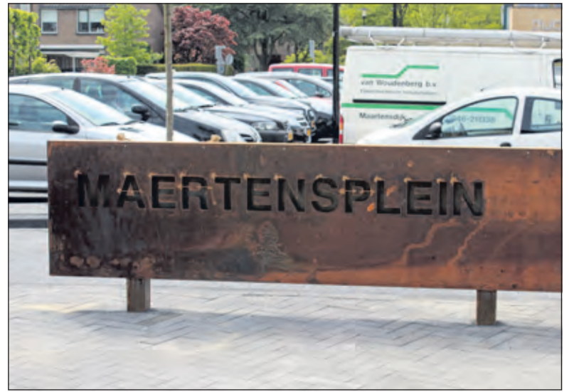
De bruine roestkleur is het meest typische uiterlijke kenmerk van het in Cortenstaal uitgevoerde naambord.
