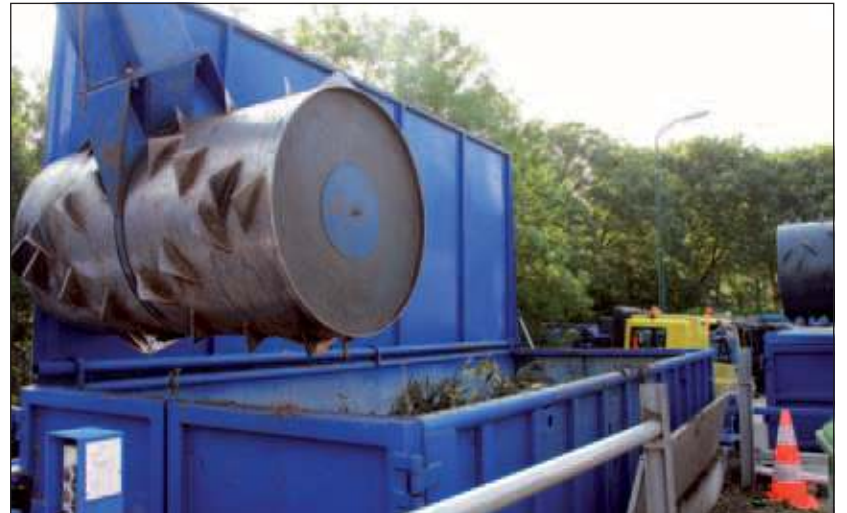
Een Roll-Over, ook wel afvalwals genoemd, perst het vuil samen, zodat de loze lucht ertussen verdwijnt. Daardoor past er meer in de containers.
