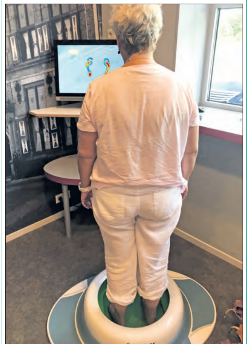
In voetscanner 'Albert' wordt een 3D beeld van de voet vastgelegd.
