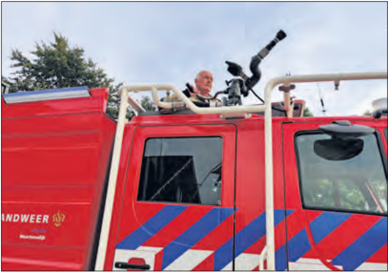
Freek de Graaf staat door het dakluik van de cabine en kan op deze manier met een van de straalpijpen een brand bestrijden.
