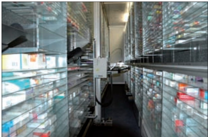
Apotheek Bilthoven beschikt over een medicijnenrobot. De robot pakt razendsnel het benodigde medicijn en legt het in een buizenstelsel, dat uitmondt op de balie.
