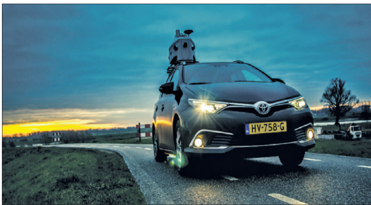
Met laserapparatuur op een auto wordt de omgeving in kaart gebracht.
